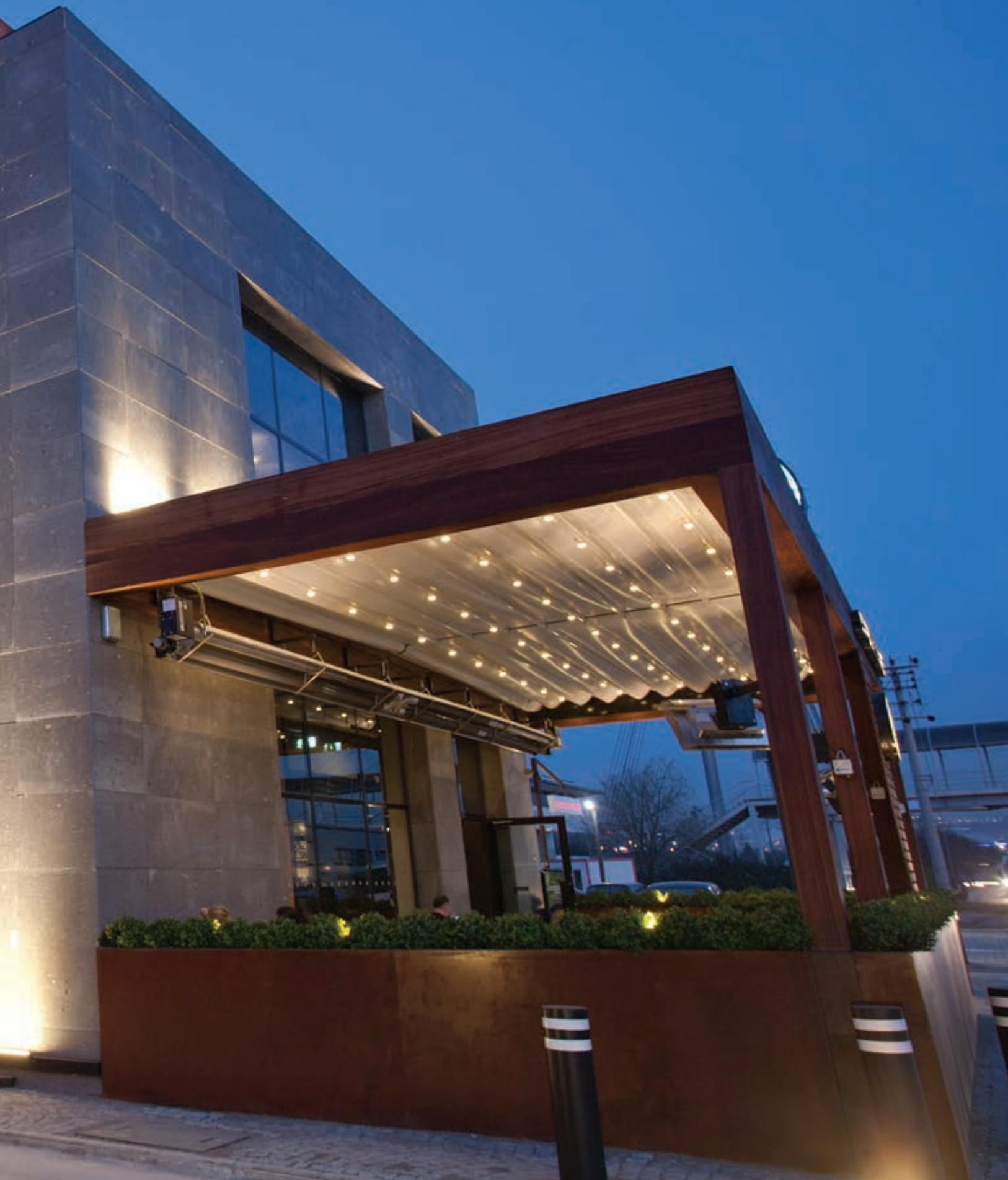
**Tr** Alev yürütmez ve %100 su geçirmez mimari blackout membran kumaş, maksimum stabilité ve sıcaklık, nem ve kir direnci sağlıyor. Üretim teknolojisi ile eşit esneme özelliğine sahip ve torbalanma yapmıyor. Akrilik üst kaplama, sonraki yıllar için temizlemeyi ve bakımı kolaylaştırıyor. Sistemdeki alüminyum koruma çatısı, kumaş kullanılmadığında koruma sağladığından kumaşın ömrü kısaltmıyor.
